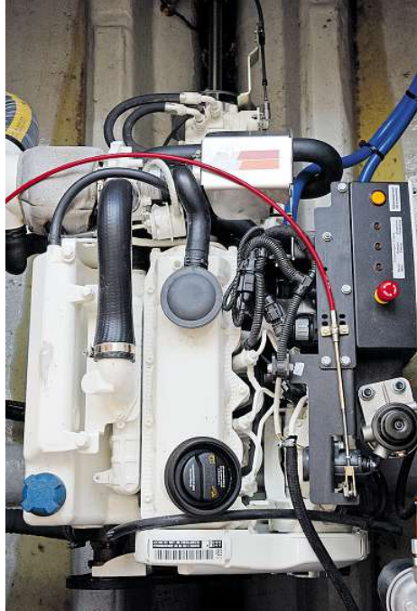
Sparsam, laufruhig und schubstark: Der vierzylindrige VW-Basisdiesel generiert 55,2 kW
