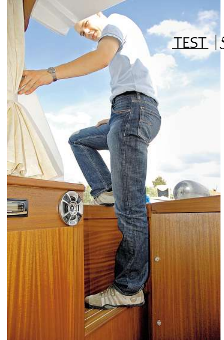
Gute Idee: Eine Zwischenstufe verkürzt den Schritt auf das Steuerbord-Laufdeck
