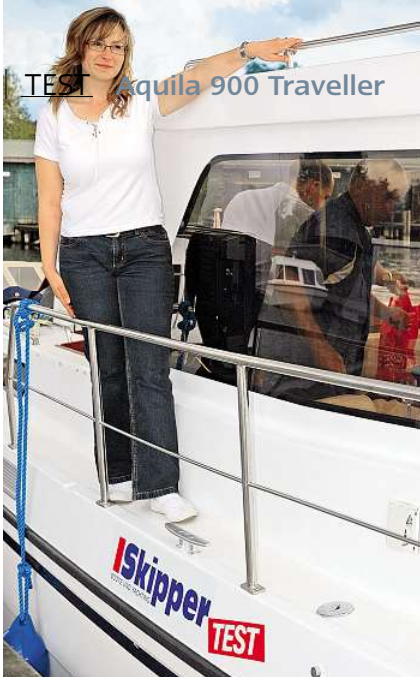
Die Gangborde sind passable 14 cm breit. Sie könnten aber grober strukturiert sein
